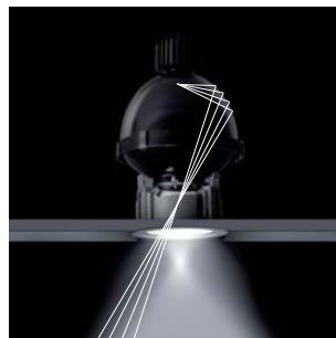
E Connect® Doppelfocusleuchten - kleine Öffnung, hohe Beleuchtungsstärken Doublefocus Luminaires - smallest openings with optimum glare control
